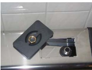
Entkalkungsabdeckung und -rohr aus Kunststoff.
